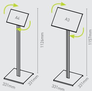
Materiale: tasche portainformazioni in policarbonato trasparente stampato ad iniezione, retro in abs bianco con copertura in alluminio anodizzato color argento. Profilo portante in alluminio anodizzato color argento, base di metallo con copertura in ABS verniciato.
