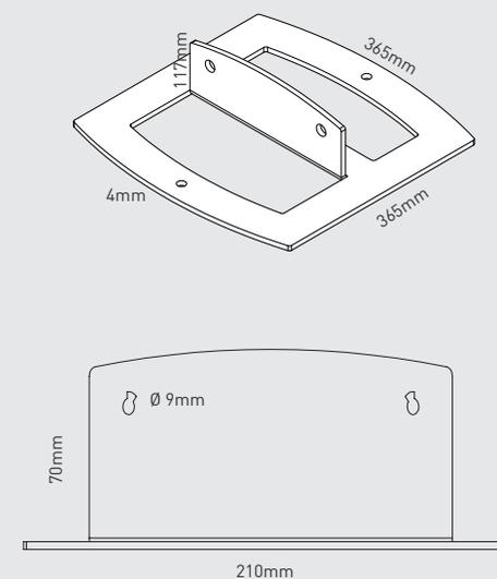
La base è realizzata in ferro da 4 mm, verniciata a polvere color antracite. Utilizzabile per pannelli di diverso peso.
